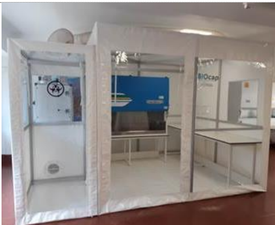
Prototipo de Biocap en presión positiva (protección del interior en relación con el entorno)
